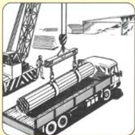
Krantraverse Typ 920 Polyestergewebe-Hebebänder DIN 61360 Typ 426
